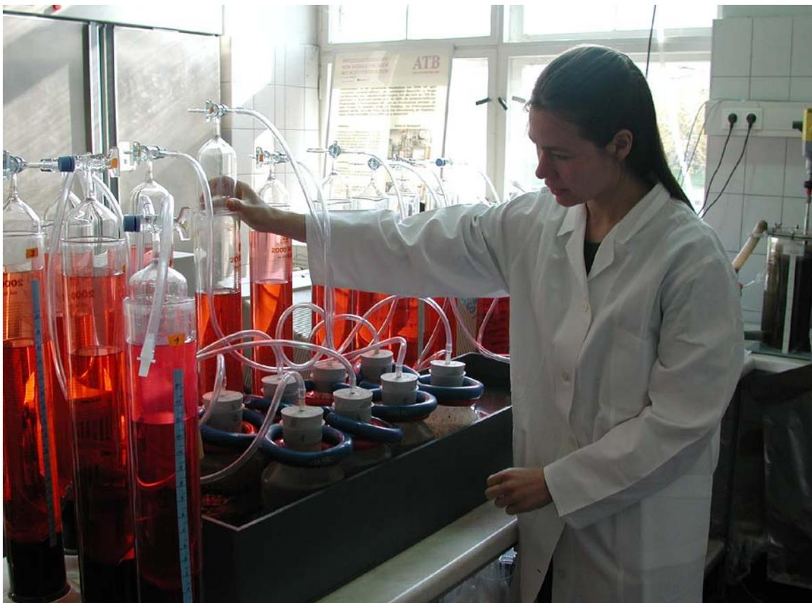
Abb. 2: Ablesung der Biogasmenge bei Gärtests (Foto ATB)
